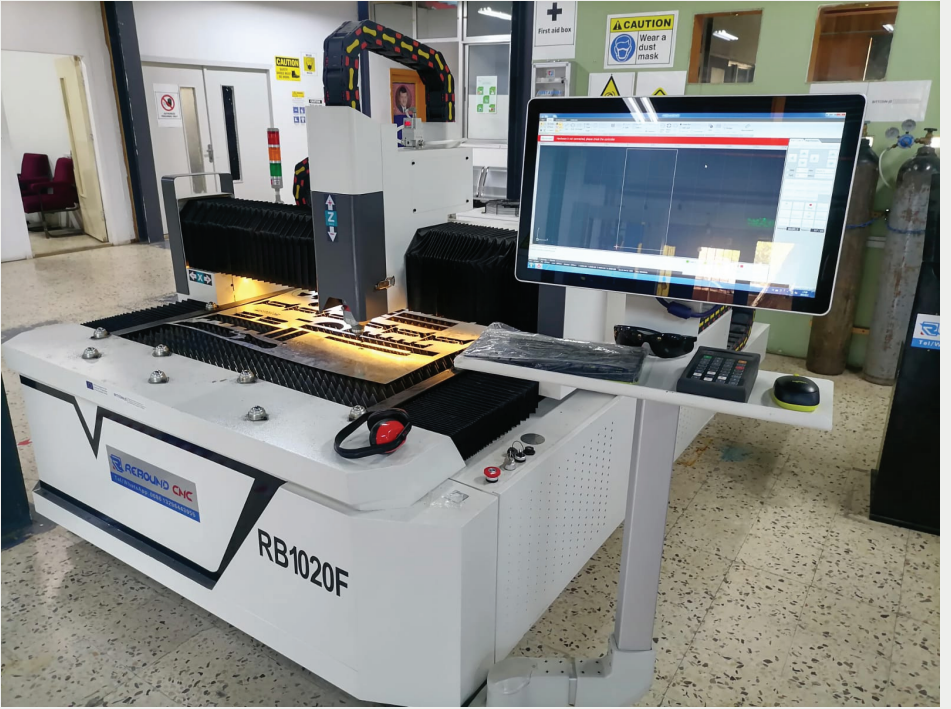
آلة القطع بالليزر CNC
