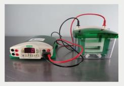
نظام الكهرباء الحثي لفصل البروتينات (Electrophoresis system)
